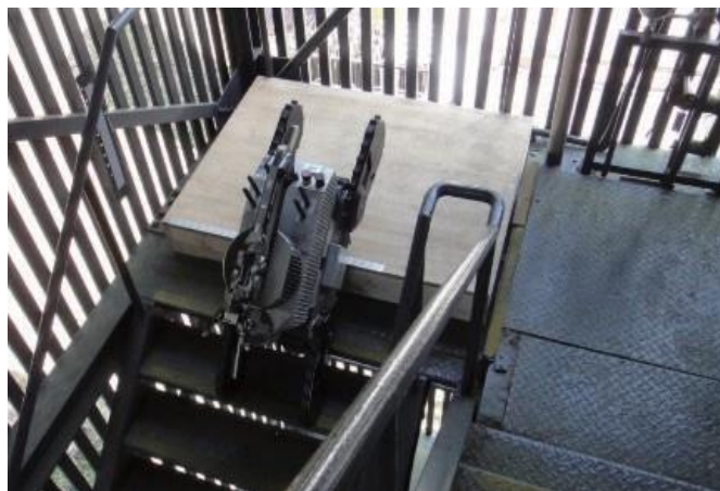
그림 7 테스트 경로의 장애물 위치에 설치된 목재 받침대
