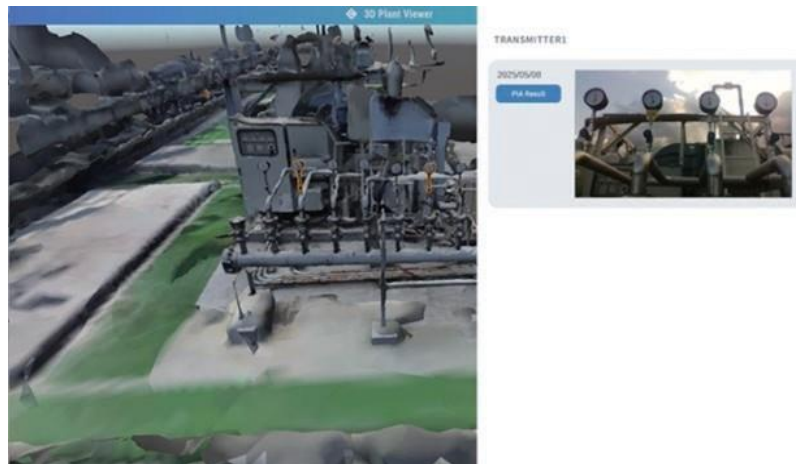
그림 12 로봇 위치 및 검사 데이터를 시각화한 3D 지도 뷰어
